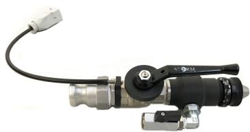
Nuova lancia bear con interruttore elettrico contact-less **078600E** La nuova lancia bear con interruttore elettrico contact-less è stata progettata per lavorare con prodotti tipo malta premiscelata, gessi e cementi aventi granulometria fino a 3 mm. Può lavorare in modo continuo con alte prestazioni. La nuova lancia bear è l'unica al mondo a montare un interruttore magnetico CONTACT-LESS, che funziona anche quando la lancia
