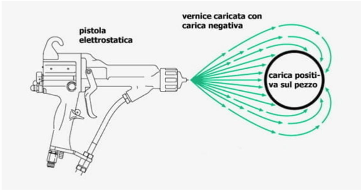
Utilizzando una vernice idrosolubile, con un grado di resistività quasi nullo, è necessario isolare totalmente il sistema di alimentazione per garantire un buon effetto elettrostatico. Vengono perciò proposti piccoli armadi isolati, con o senza ruote, per applicazioni di piccole entità oppure impianti con centrali di alimentazione su banchi isolati protetti da recinzione di protezione; entrambi esenti da usura e manutenzioni.
